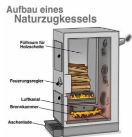
Holzheizung Aufwändig im Betrieb/Unterhalt
