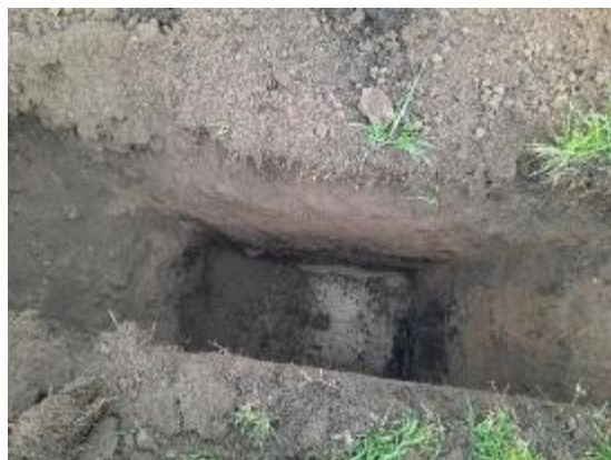
Bild 46: Sondage Nr. 2: bindiger Boden
