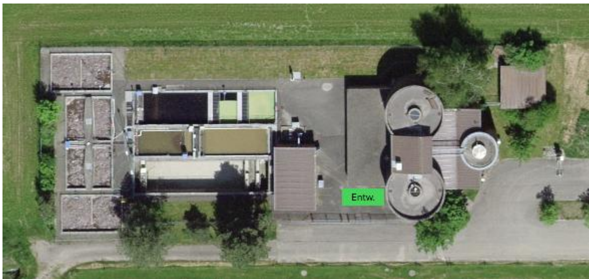
Bild 23: Aufstellungsvorschlag für die mobile Schlammentwässerungsanlage
