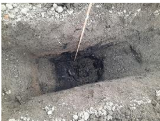
Bild 47: Sondage Nr. 3: bindiger Boden
